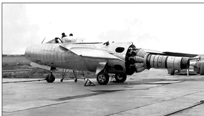
IAe 33 с отстыкованной для доступа к двигателю хвостовой секцией
