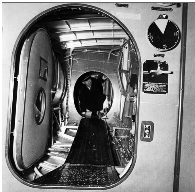
Туннель-лаз в крыле летающей лодки В-314 обеспечивал доступ бортиинженера к любому двигателю в полете
