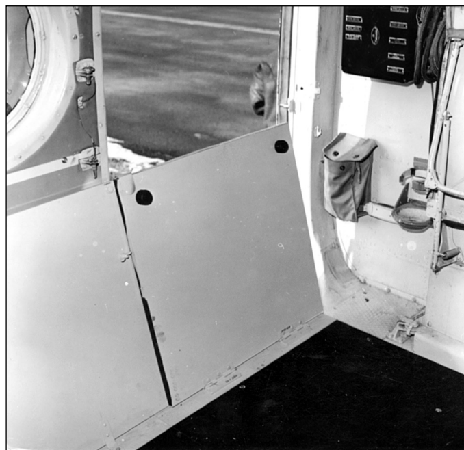
Броневые плиты у левого бортового люка Ми-8 (АТИ)
