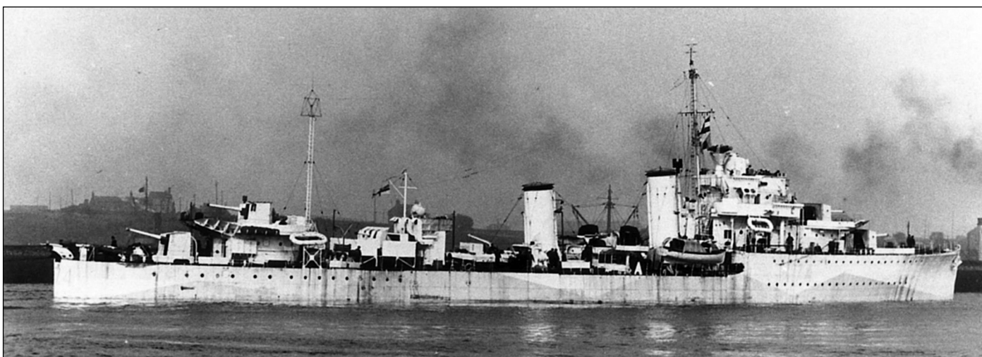
Эсминец «Форрестер» типа «F», 1943 г. Корабль имеет ограниченное противолодочное вооружение (довольно редкий случай, когда к середине войны эсминец семейства «А/Г» сохранил все свои орудия ГК), но при этом оснащен высокочастотным пеленгатором
