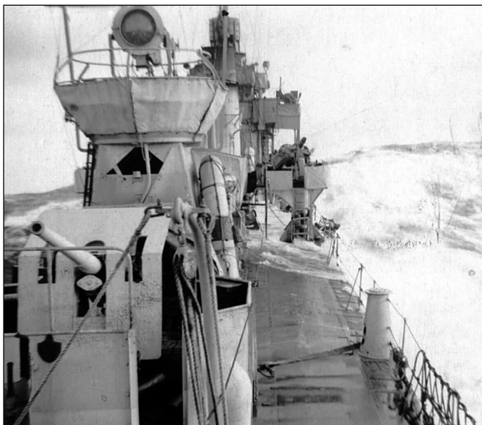
76-мм/40 (12-фунтовое) зенитное орудие Mk.V на эсминце «Валкер». Это орудие довольно легко опознать по характерному «горбтому» щиту – вторая распространенная артсистема, 76-мм/45 Mk.I как правило устанавливалась без щита
