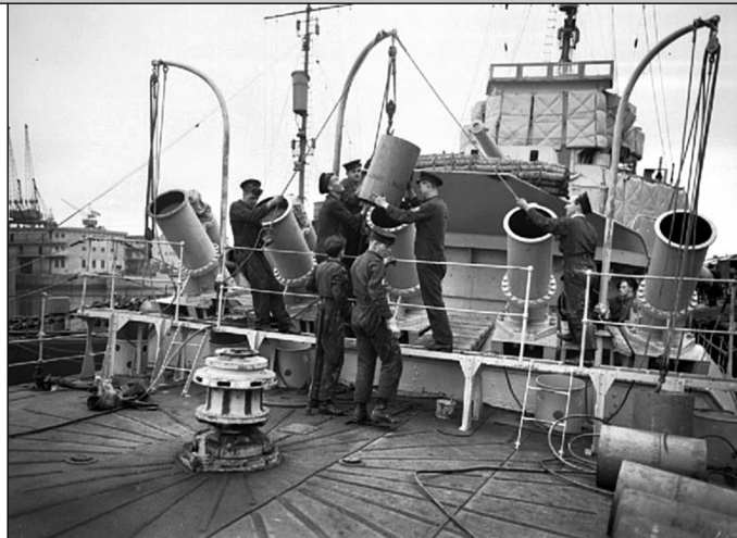
Эсминец «Уайтхолл» во время проведения испытаний экспериментального пятиствольного бомбомета, разработанного компанией «Торникрофт». В среде острых на язык британских моряков эта установка была известна как «five wide virgins» (не рискуем переводить – в силу ну очень фривольного смысла). По факту это были пять незначительно переработанных классических бортовых бомбометов, выстреливавших обычную ГБ с гидростатическим взрывателем
