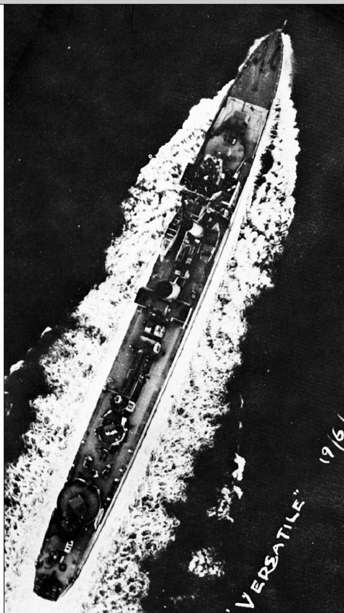
Эсминец «Версатал» типа «V» после первого и второго этапов усиления зенитного вооружения: вместо торпедного аппарата №2 смонтирована 12-фунтовая пушка на возвышенном банкете. Грот-мачта демонтирована, растяжки антенны перенесены на прожекторную площадку, площадка за второй дымовой трубой расширена, число «пом-помов» увеличено до двух, на крыльях мостика стоят два «эрликона». Фото 1942 г.
