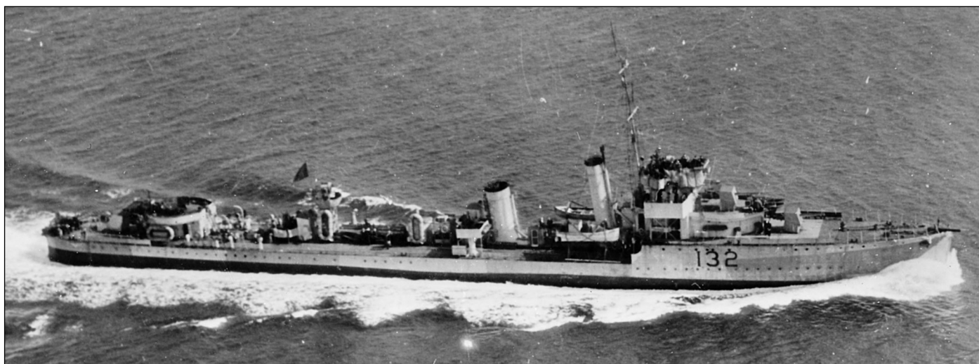
Эсминец «Версатал» типа «V» после первого и второго этапов усиления зенитного вооружения: вместо торпедного аппарата №2 смонтирована 12-фунтовая пушка на возвышенном банкете. Грот-мачта демонтирована, растяжки антенны перенесены на прожекторную площадку, площадка за второй дымовой трубой расширена, число «пом-помов» увеличено до двух, на крыльях мостика стоят два «эрликона». Фото 1942 г.
