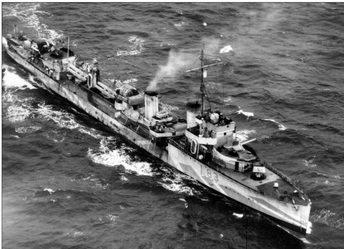
Лидер «Броук» в Северной Атлантике, октябрь 1941 г. Хорошо видна площадка с 40-мм «пом-помами» на месте среднего орудия ГК. Кормовое орудие ГК «У» также демонтировано, число бортовых бомбометов увеличено до четырех – корабль может производить т.н. «10-бомбовый залп»
