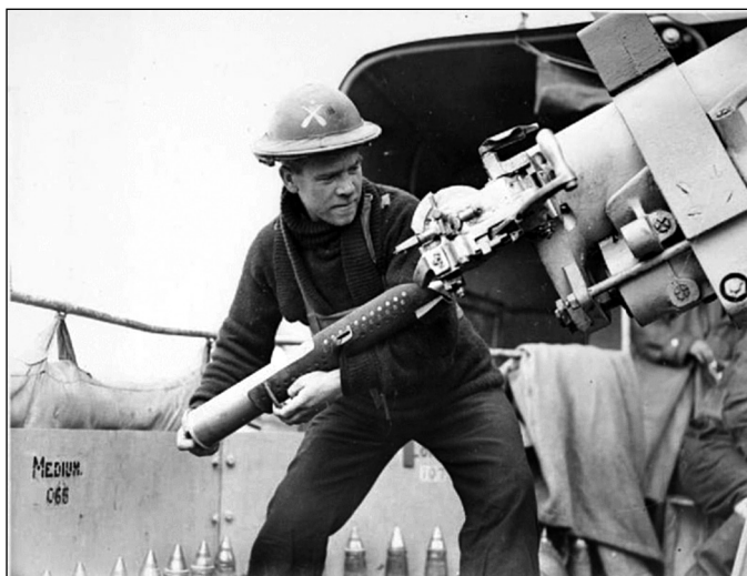
Процесс заряжания 76-мм/40 орудия на эсминце «Вэнок». Хорошо видно специальное приспособление, накинутае на шею заряжающему, позволявшее досылать снаряд и заряд одним движением, несмотря на то, что формально артсистема имела раздельно-гильзовое заряжание
