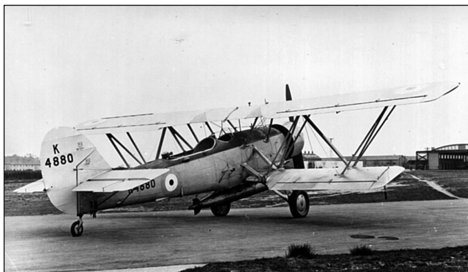
Торпедоносец-бомбардировщик-разведчик Блэкберн «Шарк» с подвешенной торпедой Mk.VIII
