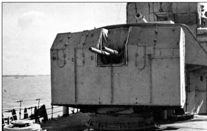
Спаренная 57-мм установка на лидере «Монтроз». На нижнем снимке орудия выведены на максимальный угол возвышения
