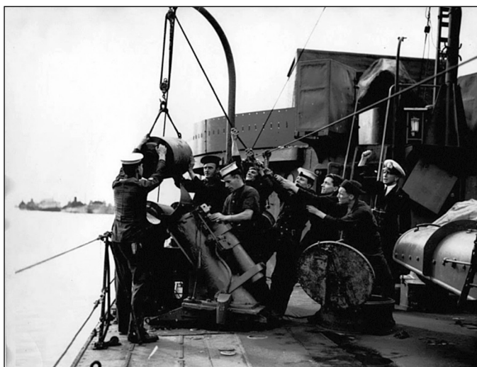
Процесс зарядки бортового бомбомета на эсминце «Энтони» типа «А»
