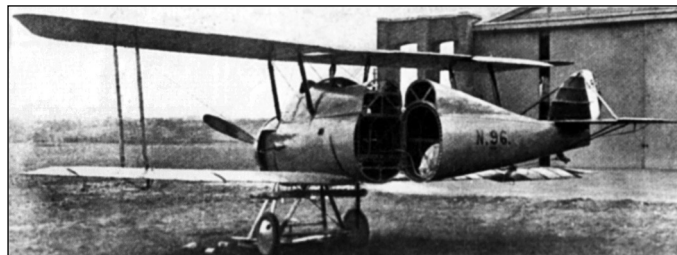
Палубный разведчик Парнелл «Пантер». Хорошо видна конструкция «переламывающегося» фюзеляжа
