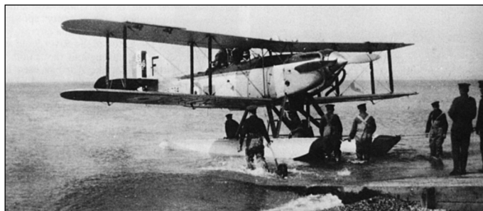
Поплавковый вариант разведчика-корректировщика Фэйри III F
