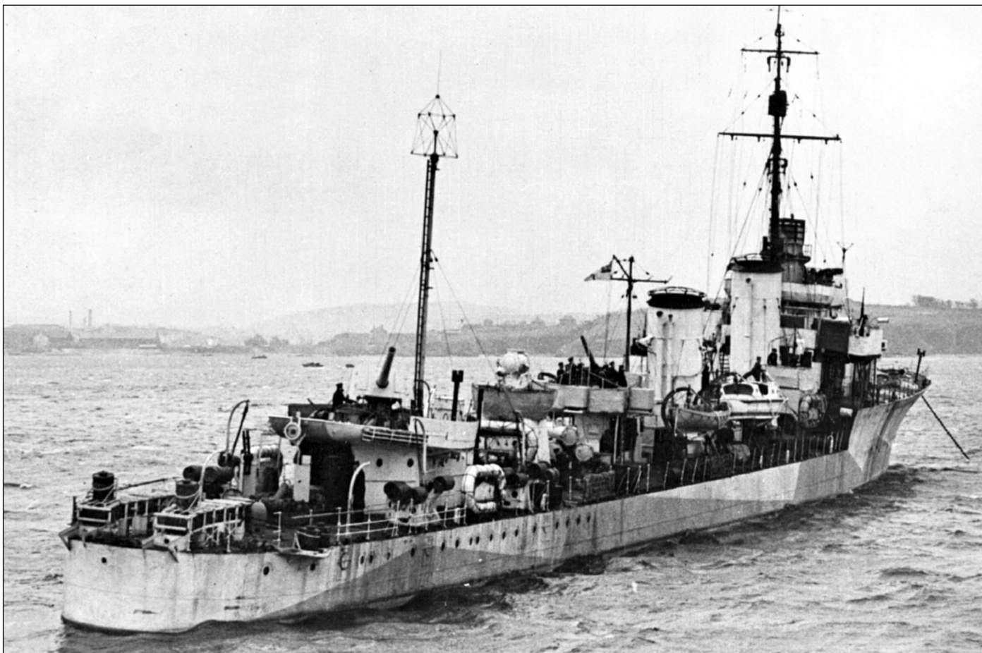
Лидер «Дуглас» в сентябре 1942 г. Корабль исполняет обязанности флагмана эскадронной группы по сопровождению конвоев через Атлантику и несет усиленное противолодочное вооружение: 4 бортовых бомбомета и два кормовых бомбосбрасывателя («10-бомбовый залп»), РБУ «Хеджеhog», РЛС «тип 271» (на носовой надстройке) и высокочастотный пеленгатор на пилоне в корме. Орудий ГК осталось всего два. Из пяти...
