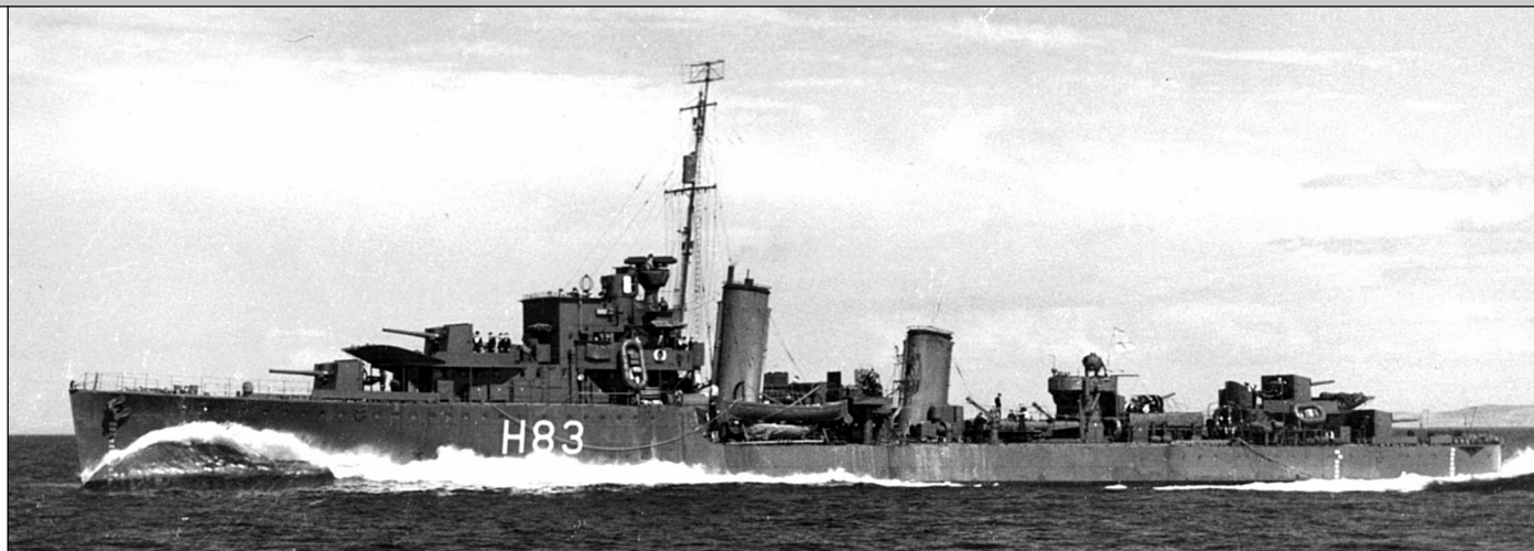
Эсминец «Вэнок» в 1941 г. Хорошо видно расположение антенны радара «тип 286» на фок-мачте. Интересно, что подобное расположение довольно редко использовалось – обычно антенна размещалась на топе фок-мачты – как на приведенном ниже снимке канадского эсминца «Сент-Лорен»
