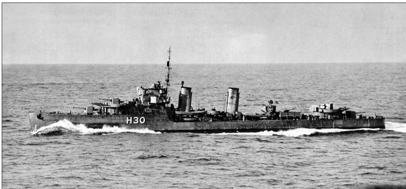
Эсминец «Бигль» типа «В», прошедший первый этап усиления зенитного вооружения: вместо торпедного аппарата №2 смонтирована 12-фунтовая пушка на возвышенном банкете. На фок-мачте оборудовано «воронье гнездо», грот-мачта демонтирована, растяжки антенны перенесены на прожекторную площадку, но вторая дымовая труба еще не укорочена. Возвышенные орудия ГК обнесены легкими защитными экранами
