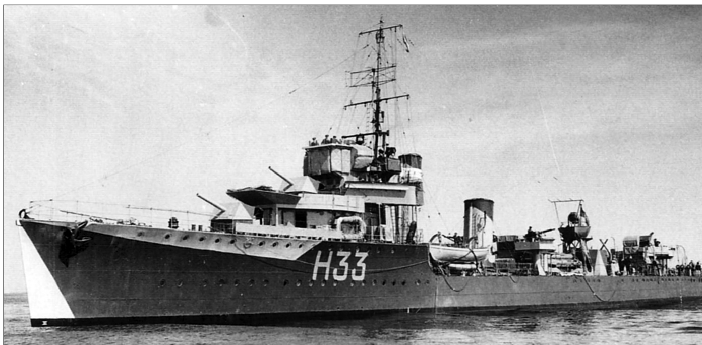
Эсминец «Вэнок» в 1941 г. Хорошо видно расположение антенны радара «тип 286» на фок-мачте. Интересно, что подобное расположение довольно редко использовалось – обычно антенна размещалась на топе фок-мачты – как на приведенном ниже снимке канадского эсминца «Сент-Лорен»
