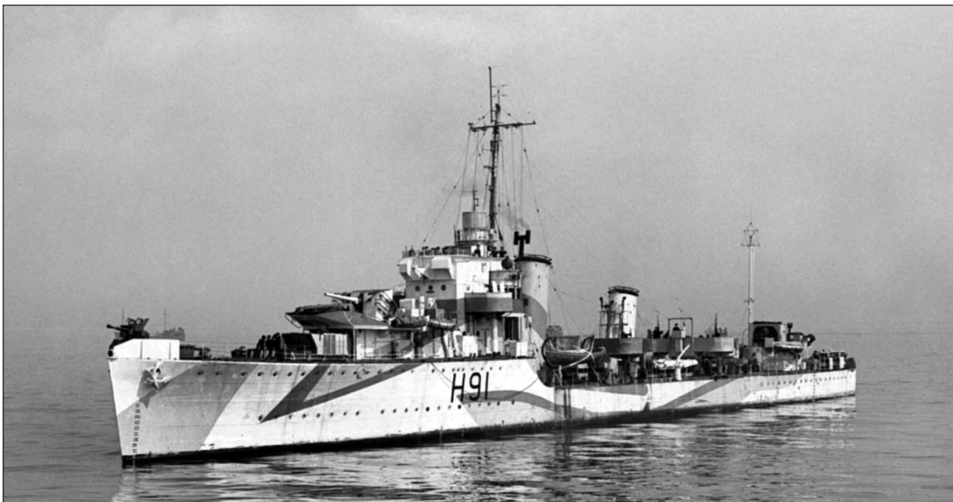
«Булдого», оснащенный противокатерным 40-мм «пом-помом», расположенным практически над форштевнем
