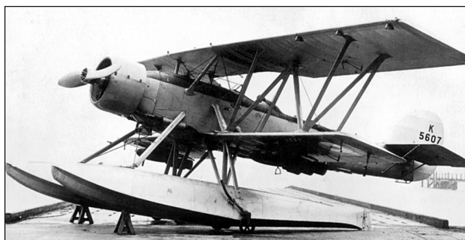
Поплавковый вариант торпедоносца-бомбардировщика-разведчика Блэкберн «Шарк»
