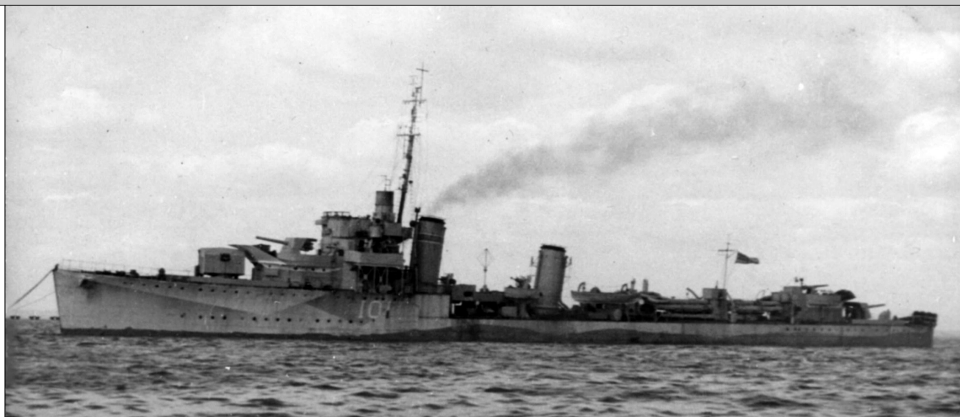
Вверху: канадский эсминец «Рэстигуш», оснащенный 57-мм противокатерными одноорудийными установками перед надстройкой, по бокам РБУ «Хеджехог» в позиции «В» Внизу: лидер «Монтроз», оснащенный спаренной 57-мм установкой на месте орудия ГК «А», 1944 г.
