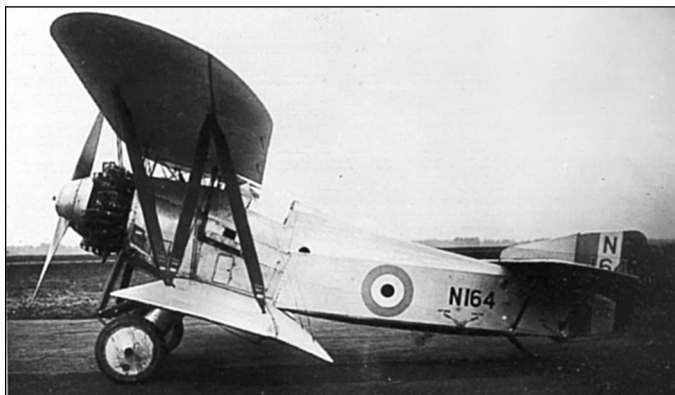
Второй прототип палубного истребителя Фэйри «Флайкэтчер», середина 1923 г.
