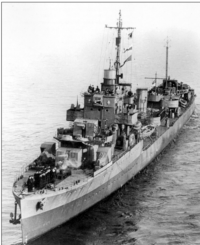
Канадский эсминец «Саскачеван» типа «Е», оснащенный «расщепленным» РБУ «Хеджеhog»
