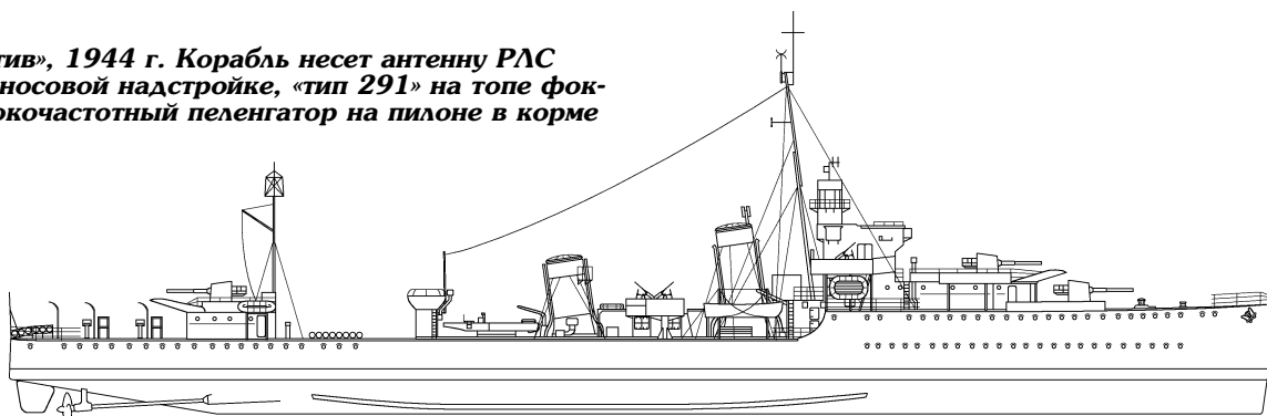
Эсминец «Уишед», 1944 г. Корабль несет антенну РЛС «тип 272» на решетчатой мачте в корме, «тип 291» на топе фок-мачты и высокочастотный пеленгатор на пилоне в корме
