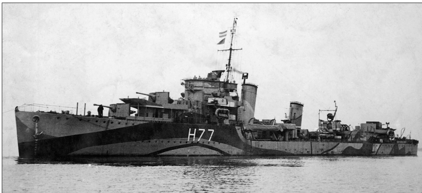
Эсминец «Бореас» типа «В». Корабль прошел первый и второй этапы усиления зенитного вооружения. На фок-мачте – антенна РЛС «тип 291»
