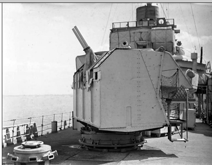
Спаренная 57-мм установка на лидере «Монтроз». На нижнем снимке орудия выведены на максимальный угол возвышения
