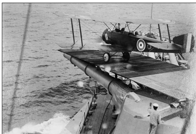
Старт разведчика Сопвич «1½ Страттер» с башенной взлетной платформы линкора «Малайя»
