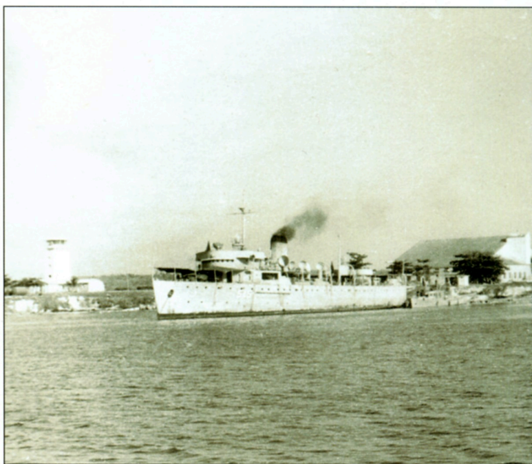
«Cuba» в послевоенный период. Треногая фок-мачта заменена облегченной однодревковой
