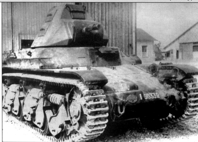
«Они поменялись местами...» Легкий танк FCM-36 с башней APX-R (вверху) и «Рено» R-35 с башней от FCM-36 (внизу)
