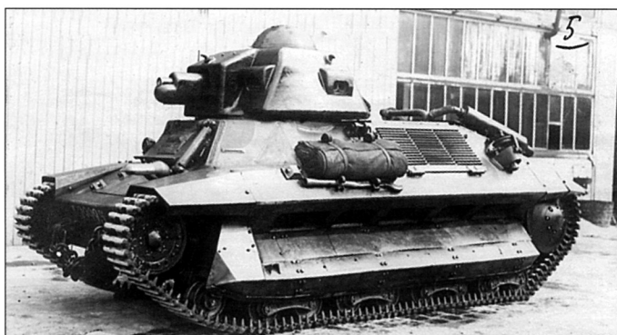
«Они поменялись местами...» Легкий танк FCM-36 с башней APX-R (вверху) и «Рено» R-35 с башней от FCM-36 (внизу)
