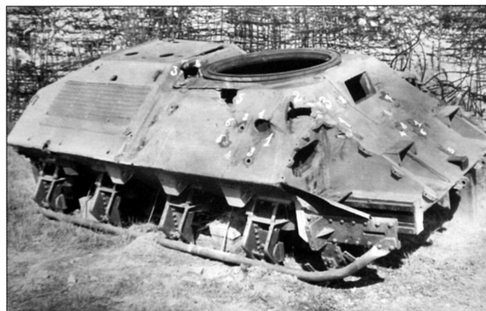
Броневой корпус, использовавшийся для испытаний обстрелом противотанковыми средствами
