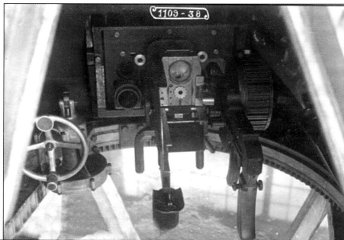
Вид через кормовой люк на место командира танка. Хорошо видна казенная часть орудия и пулемет
