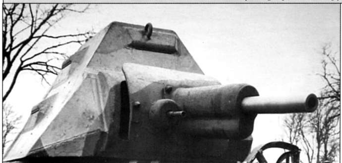
Попытка вписать 37-мм длинноствольную пушку SA38 в башню танка FCM-36 (вверху и внизу)
