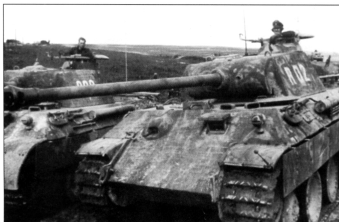
Командирские «Пантеры» Panzerbefehlswagen Sd.Kfz. 267 из состава 5-го танкового полка СС - танки командира полка и его адъютанта. От линейных машин они отличались установкой дополнительных радиостанций (одна из них с характерной «метелкой» антенны) и уменьшенным боекомплектом. Снимок сделан весной 1944 г. во время боевой подготовки «Викинга». Интересно, что вместо комполка Мюленкампа в его «Пантере» (слева) находится командир 8-й роты Николусси-Лек. В танке справа - гауптштурмфюрер СС Ганс Флюгель
