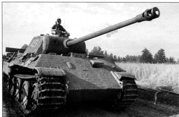
«Пантера» №833 из состава 5-й танковой дивизии СС «Викинг» в Польше. Лето, 1944 г. Машина имеет циммеритное покрытие. Вероятно, из-за повреждения огнем противника танк утратил часть из своих 5-мм броневых экранов
