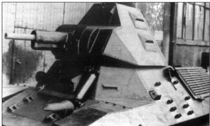
Попытка вписать 37-мм длинноствольную пушку SA38 в башню танка FCM-36 (вверху и внизу)
