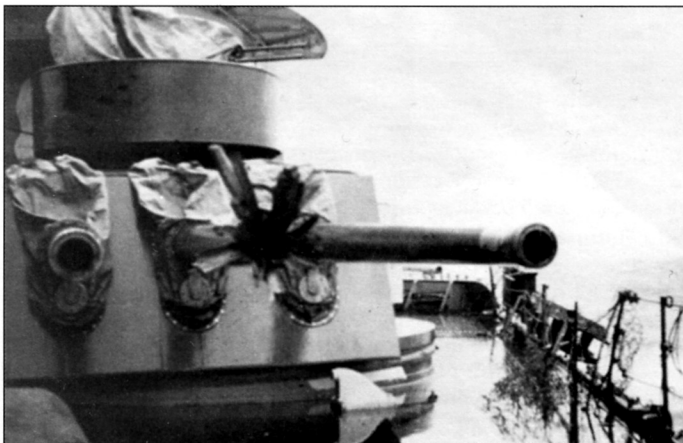
Разрыв ствола 152-мм орудия линкора «Литторио» во время боя в заливе Сирт
