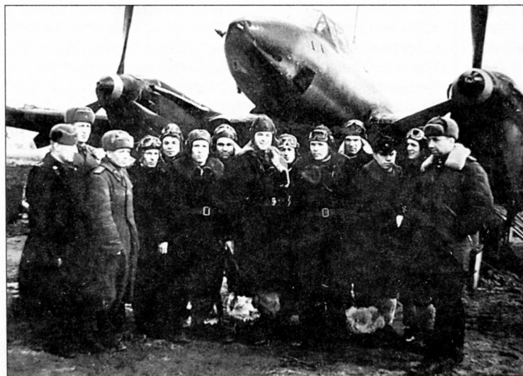
Личный состав звена 2-го апр ГК КА у самолета Пе-3. Остекление носовой части несимметрично в связи с установкой дополнительного пулемета БК (его обтекатель в правой нижней панели неплохо виден, как и ствол второго пулемета УБК справа по полету)
