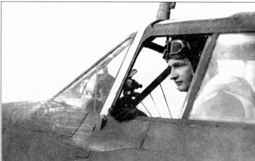
Командир 12-го гв. бап майор Василий Раков в кабине Пе-2 . На боковых стеклах козырька фонаря кабины видны нарисованные линии, с помощью которых пилот выдерживал заданный угол пикирования, совмещающая их с линией горизонта
