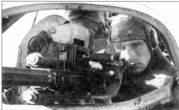
Штурман «пешки» у пулемета БТ, смонтированного на турели «ФТ». Наведение оружия на цель осуществлялось с использованием прицела КВ-Т
