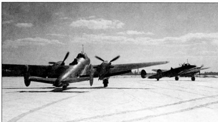
Пикирующие бомбардировщики 12-го гв. бап выруливают на старт. Стрелки стоят на полу фюзеляжей, обеспечивая безопасность руления (они должны были предупреждать командира экипажа в случае опасного сближения при маневрировании на земле)
