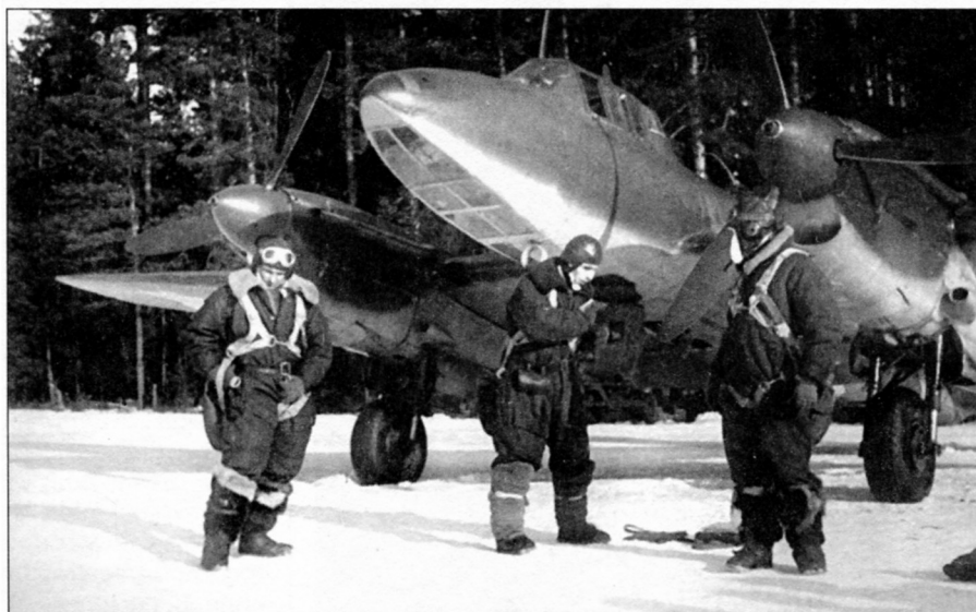
Экипаж самолета-разведчика поздней серии выпуска собирается в путь. Виден открытый люк кабины летчика и штурмана, а позади него два отверстия для объективов фотоаппаратов в створках отсека полезной нагрузки. Антенна радиополукомпаса РПК-10 «Чаенок» имеет форму кольца
