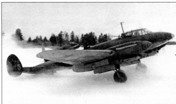
Для повышения обороноспособности самолета от атак истребителей сверху-сзади с весны 1942 г. ШКАС на турели штурмана заменили крупнокалиберным пулеметом БТ. Неофициально этот вариант машины называли Пе-2 ФТ («фронт требует»)
