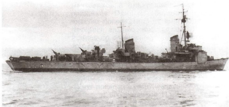
Т-28 на Балтике, начало 1945 г. На месте кормового проектора установлена антенна РЛС FuMO-63
