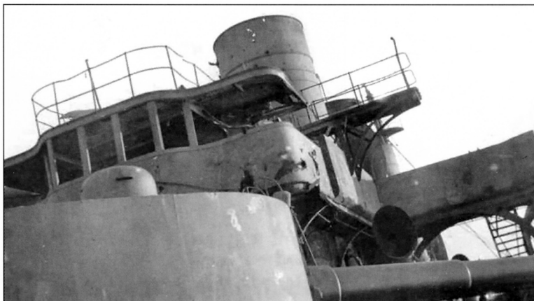
Разрушения на верхней палубе и надстройках эскадренного броненосца «Победа»
