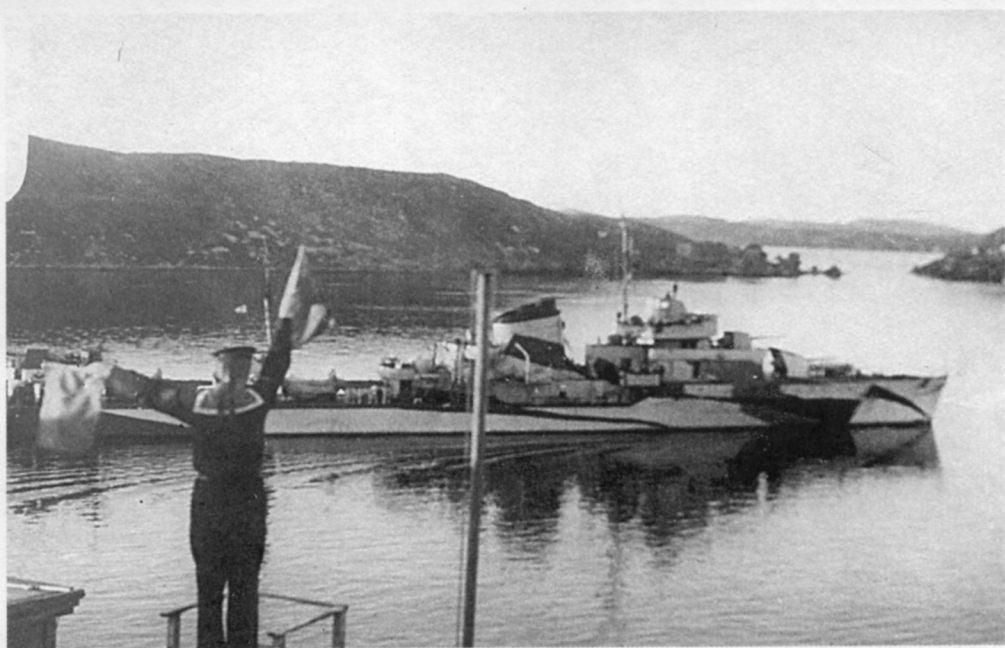
«Гремящий» после демонтажа козырьков над 1-м и 4-м орудиями ГК и переделки щитов по типу черноморских эсминцев, примерно 1943 — 1944 гг.
