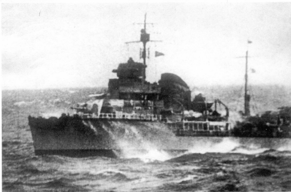
Эсминец «Бдительный» в штормовом море, зима 1941/42 г. Из-за короткого полубака и незначительного развала носовых шпангоутов при зарывании в волну корабль полностью закрывало облако брызг.
