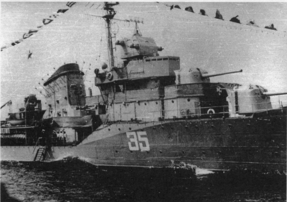
Эсминцы проекта 7, прошедшие капитальный ремонт и перевооружение до принятия типового проекта модернизации ЦКБ-53: «Гремящий», «Бойкий» и «Стерегающий» (сверху вниз). На этих кораблях сохранились однодеревковые фок-мачты, а на «Гремящем» — даже орудия Б-13 1-й серии с прямоугольными щитами. Однако зенитная артиллерия на всех эсминцах была заменена на четыре спаренные 37-мм артустановки В-11.
