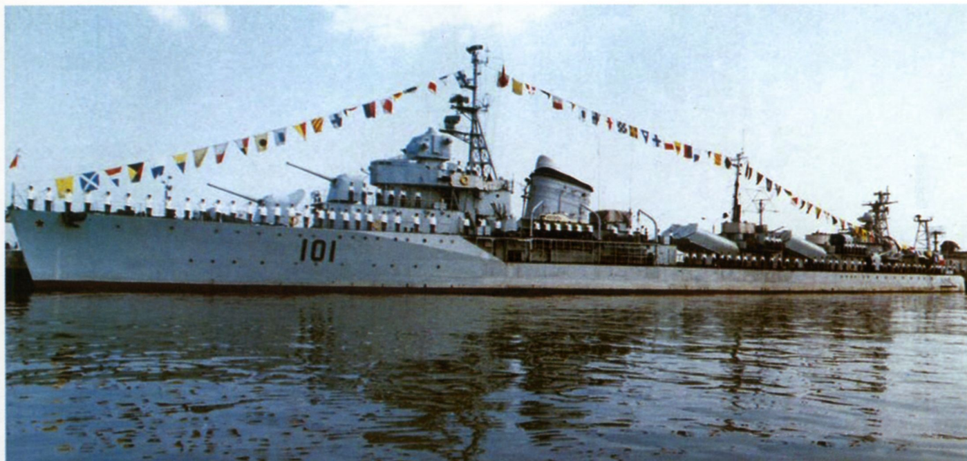
Эсминец «Аньшань» (бывший «Рекордный») после перевооружения ракетами.
