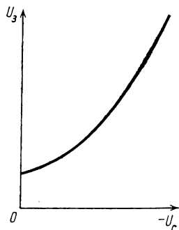
Рис. 1. Пусковая характеристика тиратрона
