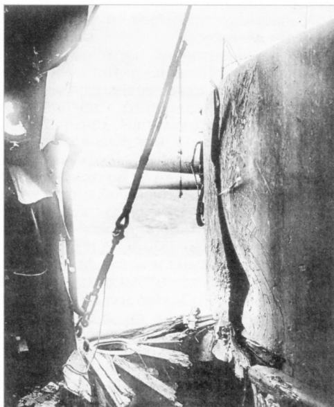
«Орел». Пробоина в неброниро- ванной надводной части правого борта в районе средней 152-мм башенной установки
