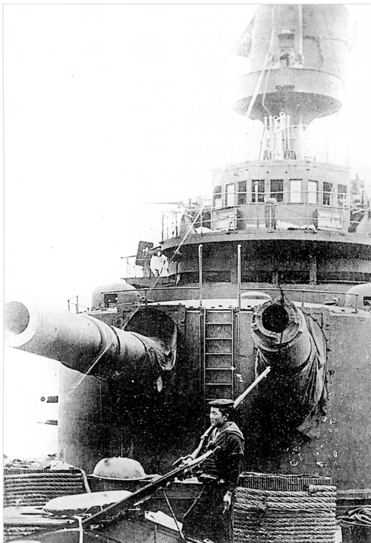
Эскадренный броненосец «Орел». Носовая 305-мм башенная установка с поврежденным левым стволом
