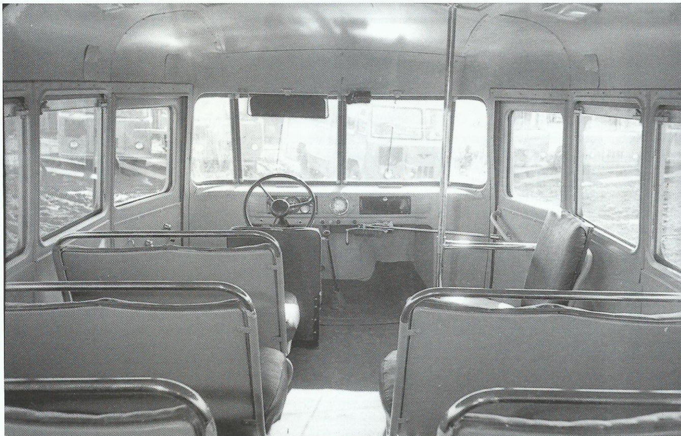
▲ Салон капотного автобуса ПАЗ-651. На фотографии хорошо виден кулисно-рычажный механизм входной двери, с ручкой около места водителя
