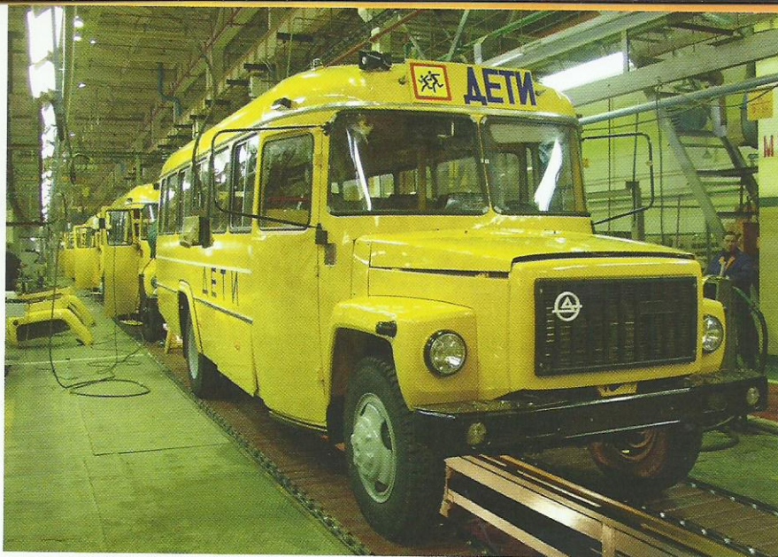
♣ Сборочный конвейер капотных автобусов КАвЗ
