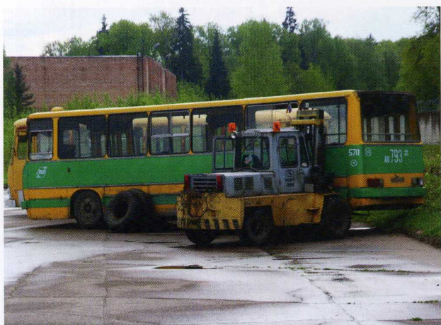
«Икарус-260» подготавливается для испытаний краш-теста барьерного ограждения на Автополигоне НАМИ, 2009 г.
