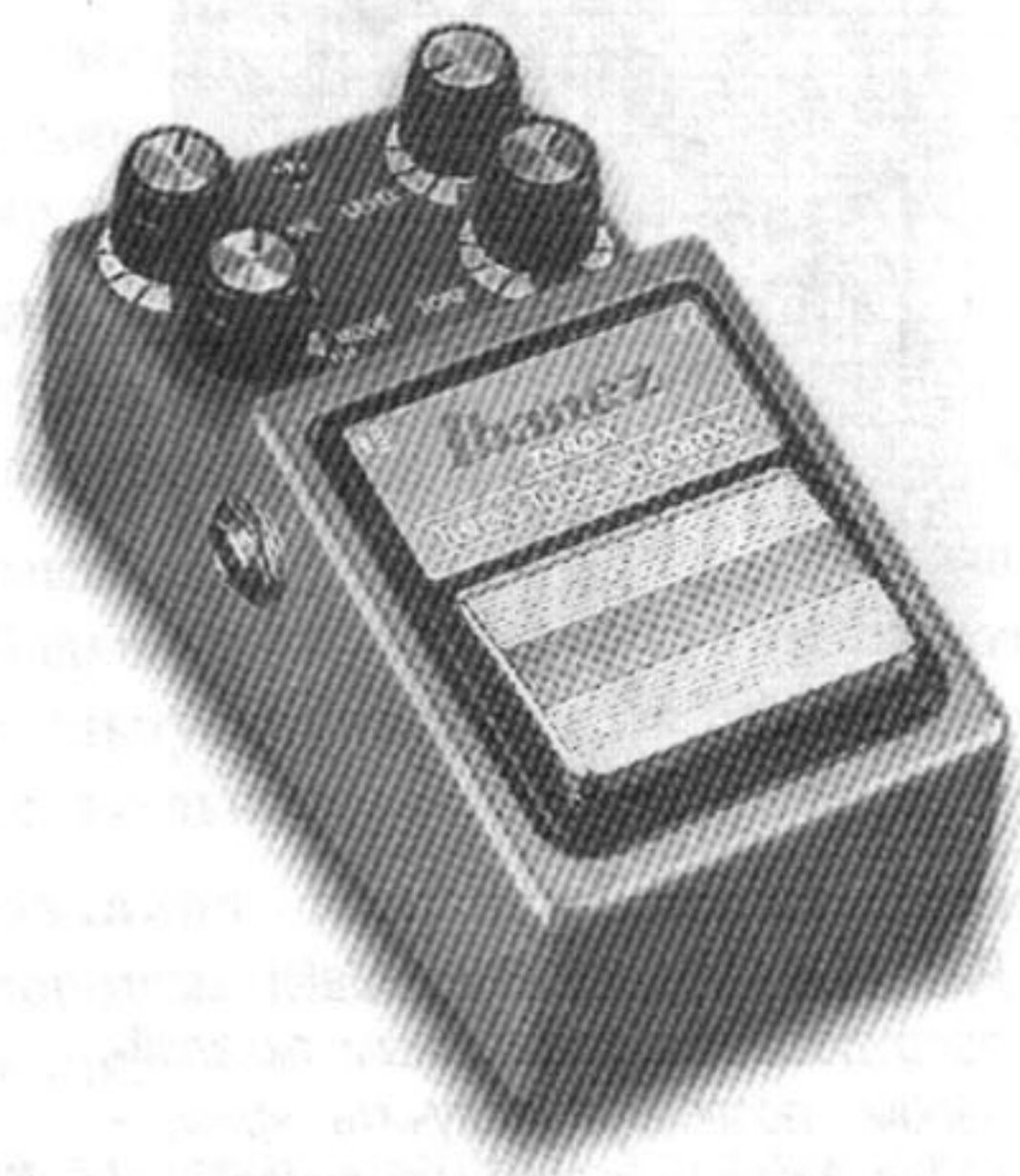
Рис. 15.1. Хотя вся электроника эффекта Ibanez Tube Screamer является полупроводниковой, эта модель стала классической благодаря обеспечиваемому с ее помощью овердрайву, очень похожему на ламповый овердрайв
