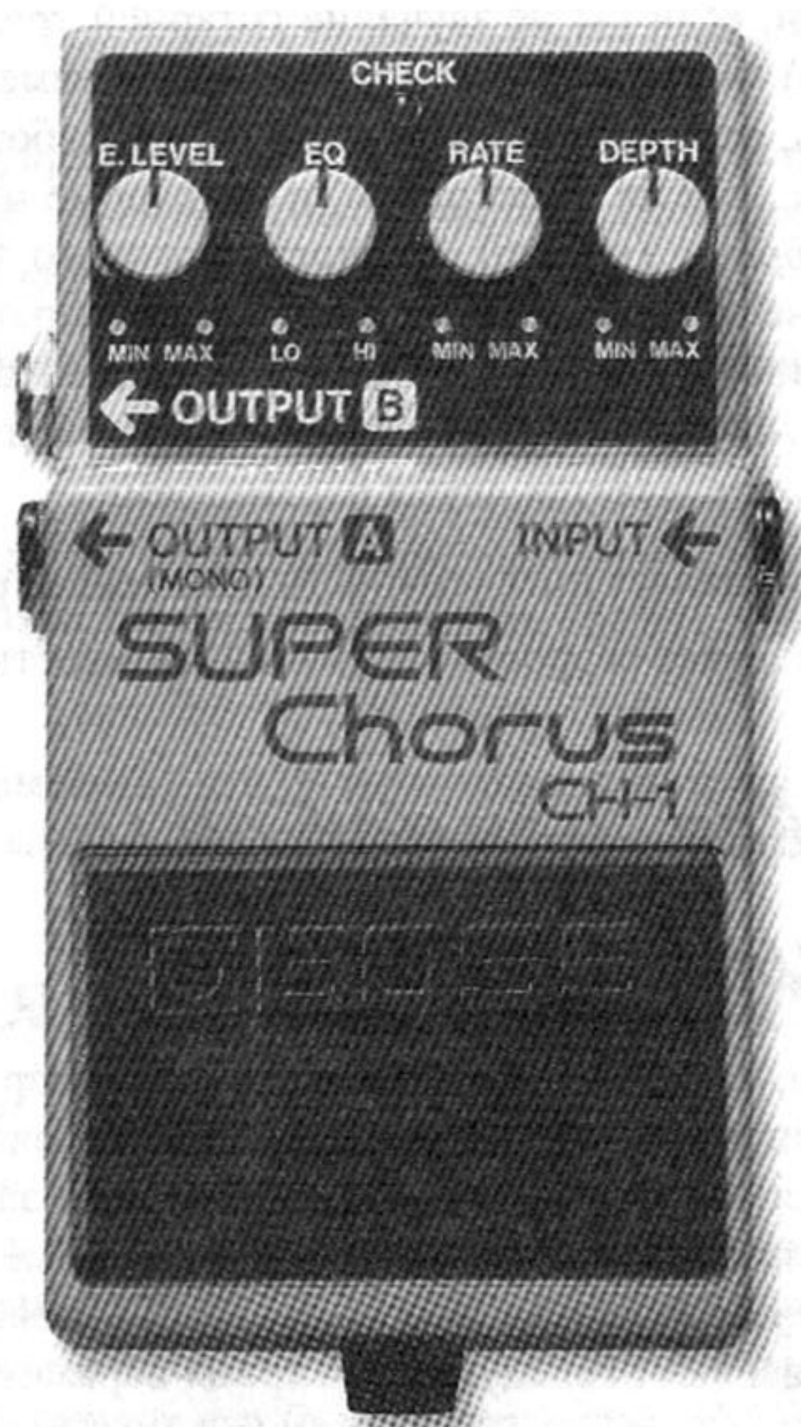
Рис. 15.6. Два выхода эффекта Boss CH-1 Super Chorus позволяют преобразовать монофонический гитарный сигнал в стереофонический
