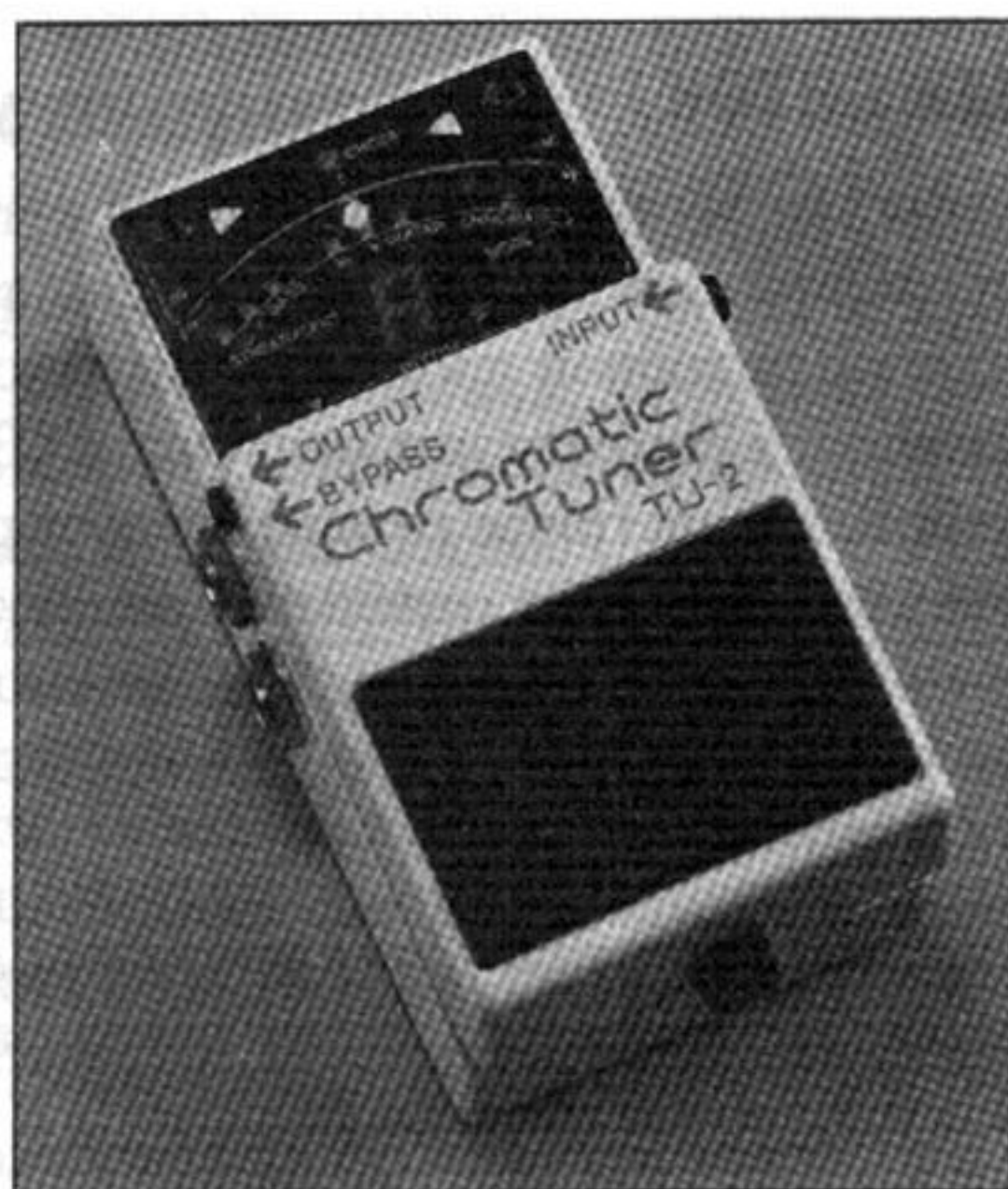
Рис. 2.7. Камертон Boss TU-2 оборудован шкалой, позволяющей легко определить, в какую сторону отклоняется звук настраиваемой струны, и светодиодным индикатором, предназначенным для отображения ближайшей эталонной ноты
