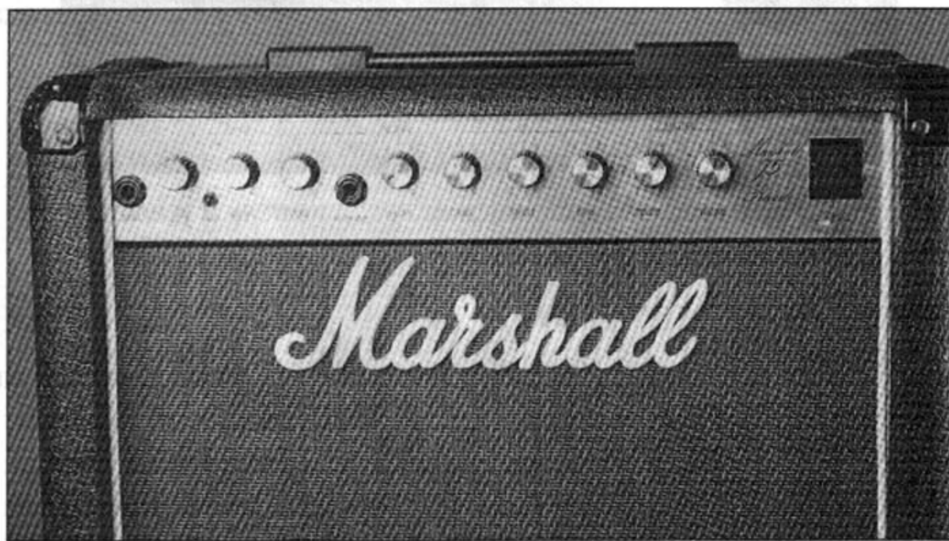
Рис. 3.2. Панель управления служит для размещения разъемов, переключателей и регуляторов усилителя
