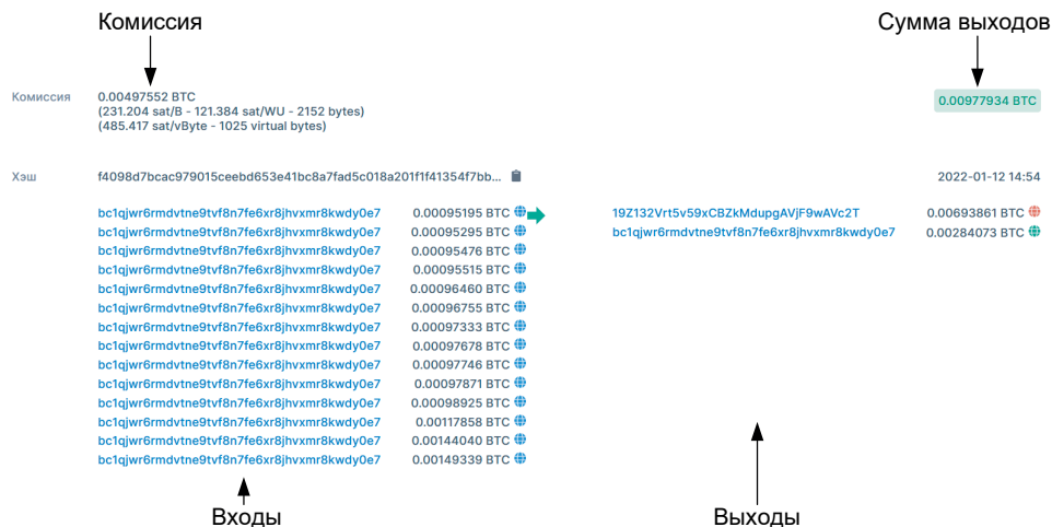
Рисунок 4.12. Входы и выходы транзакции в блоке биткойна с высотой 718 300
