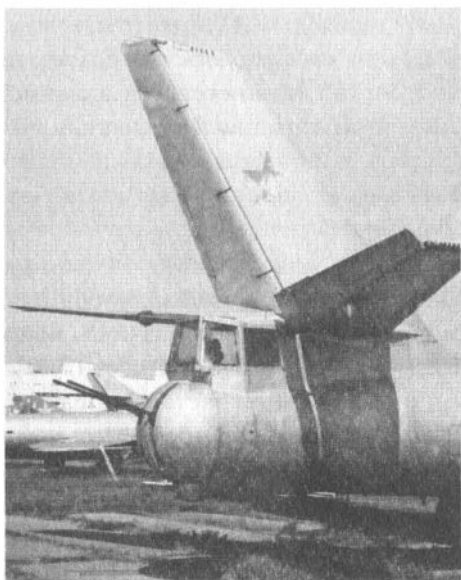
Кормовая артиллерийская установка Ил-К6 бомбардировщика Ил-28
