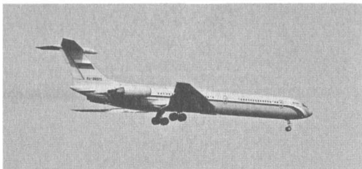
Ил-62М. Хорошо видна механизация крыла
