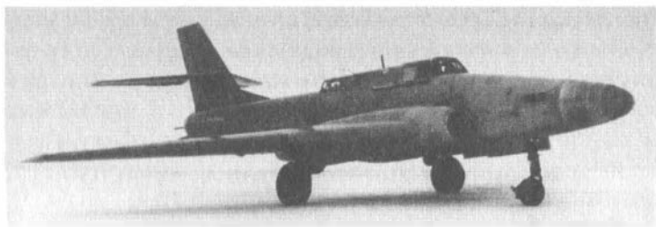
Первый, доработанный в четырехпушечный вариант, реактивный бронированный штурмовик Ил-40
