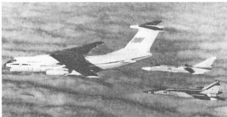
Дозаправка топливом фронтового бомбардировщика Су-24 и истребителя-перехватчика МиГ-31 от танкера Ил-78М
