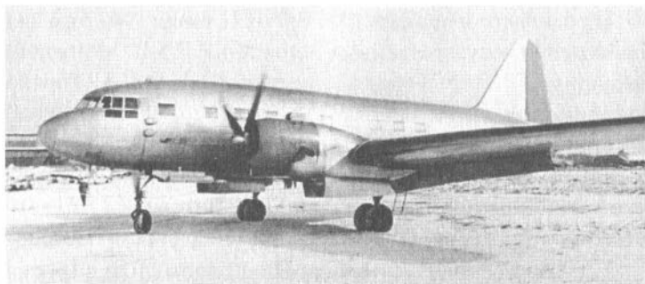
Первый прототип Ил-12 с двигателями АШ-82ФН на испытательном аэродроме
