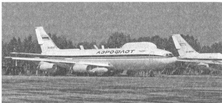
Самолет Ил-80 — воздушный пункт управления, созданный на базе Ил-86
