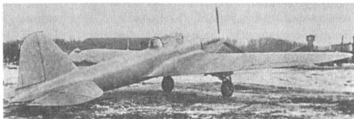
ЦКБ-55 (БШ-2) с мотором АМ-35 — первый двухместный прототип штурмовика Ил-2
