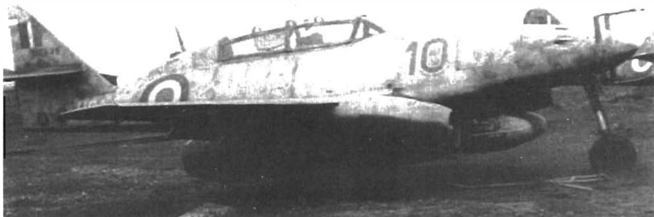
Истребитель-перехватчик Me.262B-1a/U1 с РЛС и подвесными топливными баками с английскими опознавательными знаками
