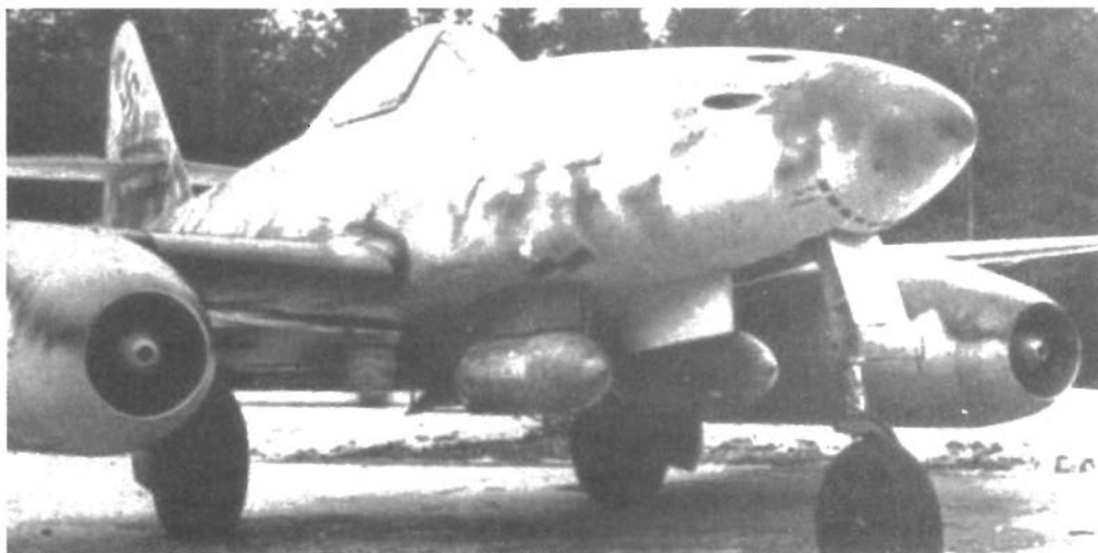
Истребитель-бомбардировщик Me.262A-2a с двумя бомбами калибра 250 кг
