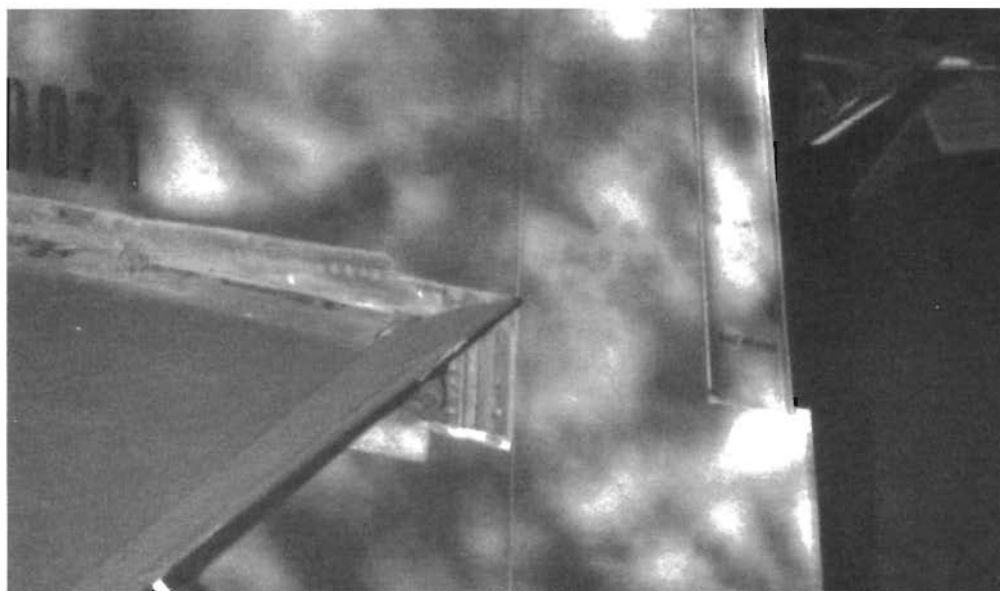
Вид на хвостовую часть самолета. Стабилизатор и руль направления оборудованы триммерами
