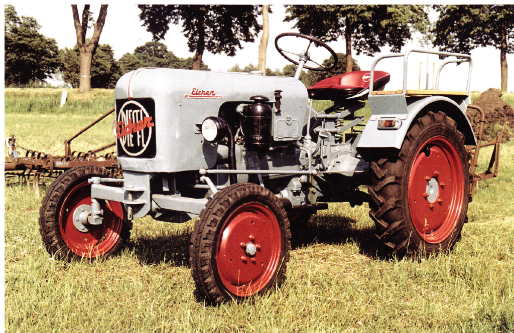
Трактор «Айхер» ED 22 использует серийное заднее прицепное приспособление. Среди дополнительных орудий есть и другие агрегаты, например косилка, навешиваемая сбоку.
