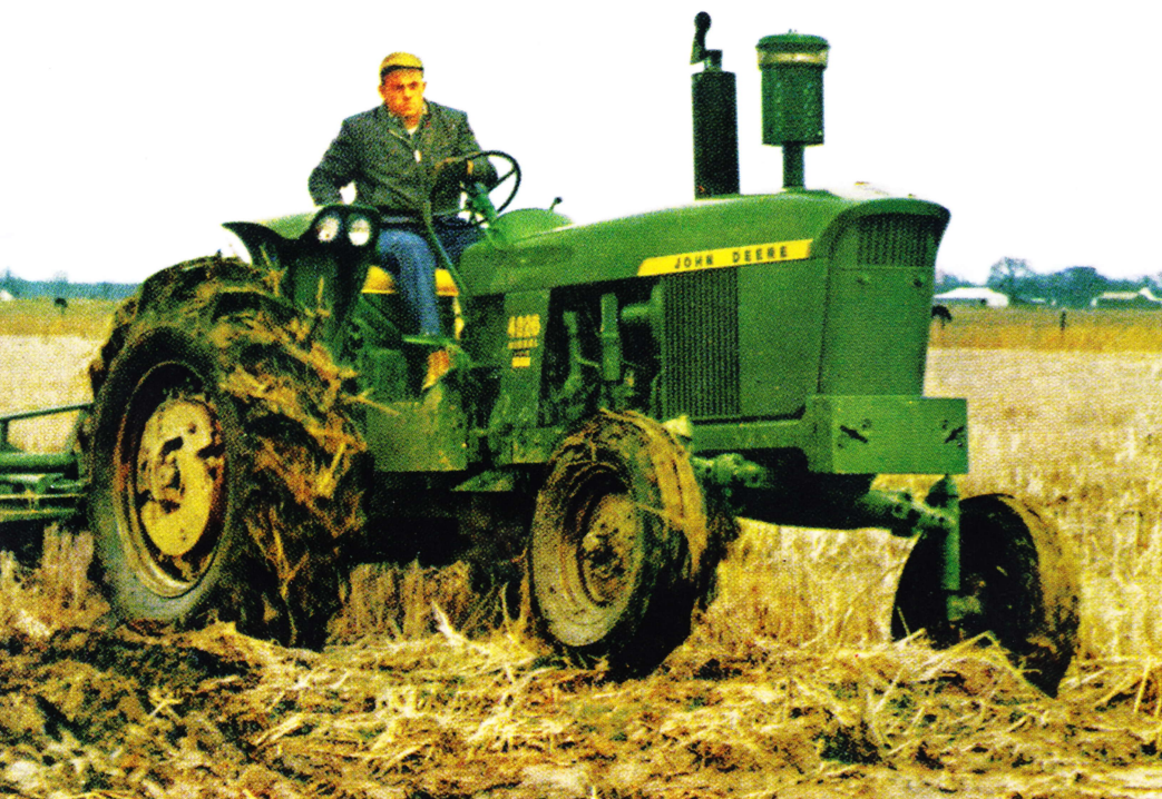
Трактор «Джон Дир 4020» 1966 года выпуска, с шестицилиндровым двигателем рабочим объемом 6620 см 3 и мощностью 100 л. с.
