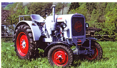
Маятниковая подвеска передней оси помогает ED 25/II отлично передвигаться по пересеченной местности.
