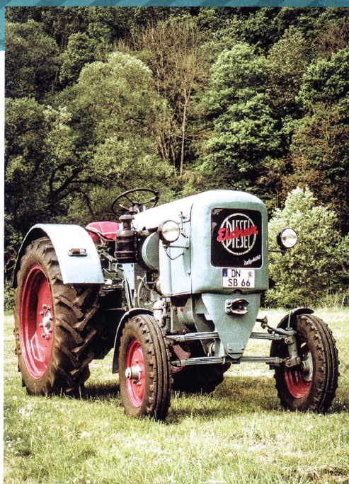
У модели ED 25/II, как и во всех тракторах линейки, сиденье водителя с параллелограммной подвеской.
