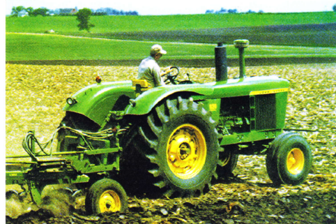
Доступная в Европе с 1965 года модель 5020 дает мощность 122 л. с. при сухом весе 7800 кг.
