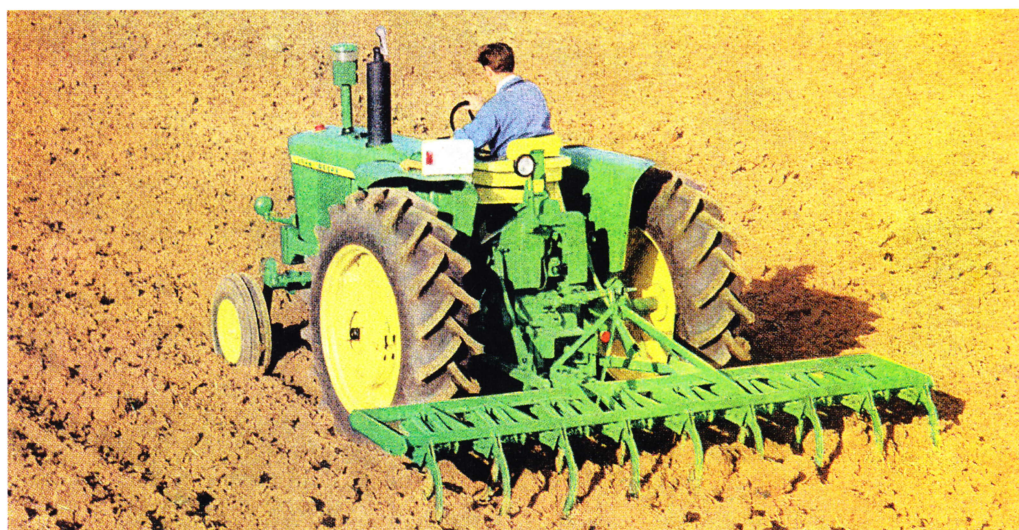
Четырехцилиндровый двигатель 3020 объемом 4425 см 3 с 1965 года дает мощность 75 л. с. По передней фаре и номерному знаку сзади это модель 3020 для европейского рынка.
