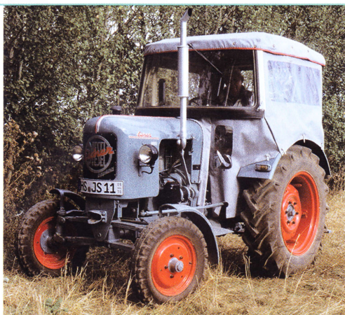
Дизельный трактор «Айхер» со специальным всепогодным дооборудованием – полностью закрытой кабиной и дополнительными грязезащитными крыльями передних колес.
