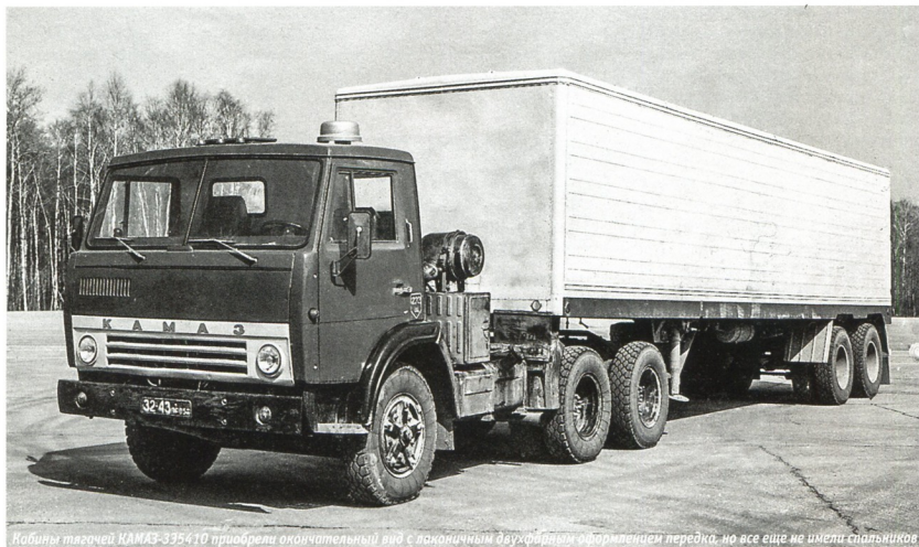
Кабины тягачей КАМАЗ-335410 приобрели окончательный вид с лаконичным двухфарным оформлением передка, но все еще не имели спальников
