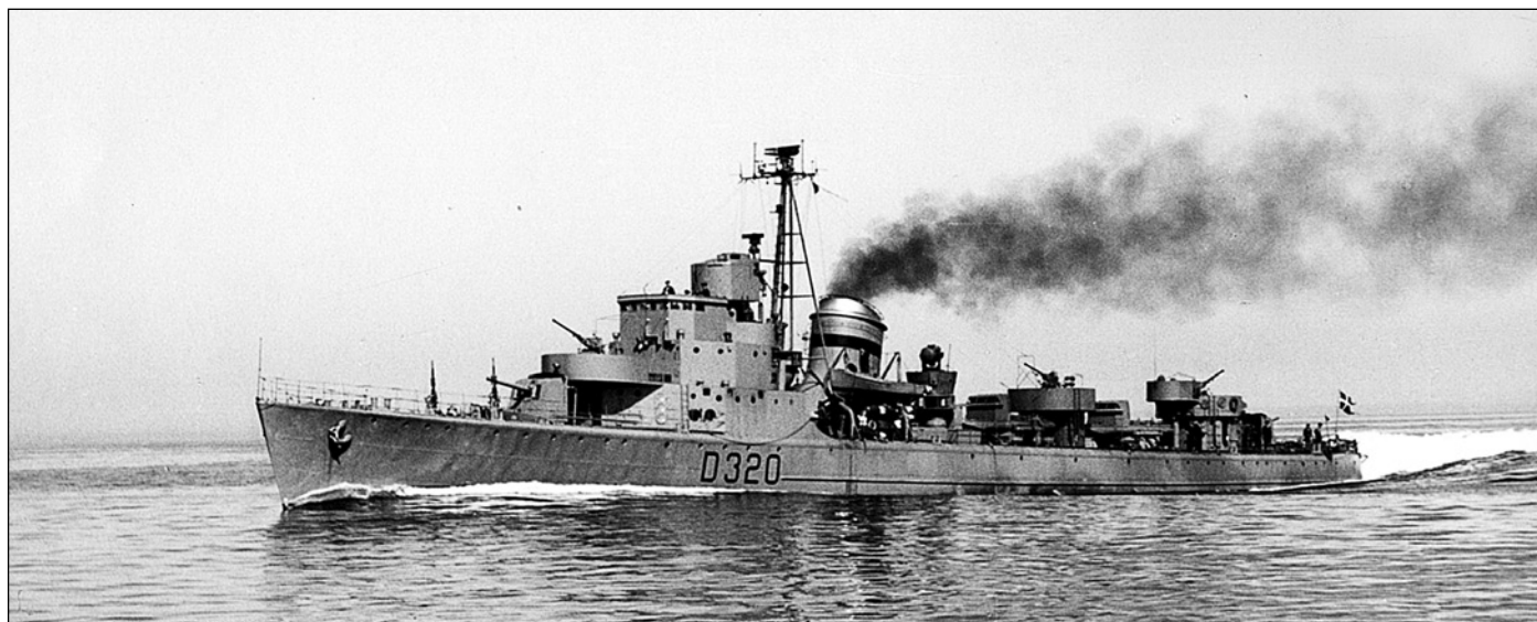
Полная движения фотография «Витфельда», сделанная после первой перестройки миноносца в 1951 году. Прекрасно видно, что корабль уже получил третий 40-мм автомат и новые торпедные аппараты. Однако на баке еще сохраняется пара 20-мм «Мадсенов». В этот период он нес красную марку на дымовой трубе.
