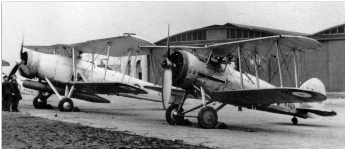
«Гонтлет», оснащенный более широкими пневматиками для облегчения эксплуатации с песчаных аэродромов. На заднем плане – торпедоносец «Фэйри Суордфиш»
