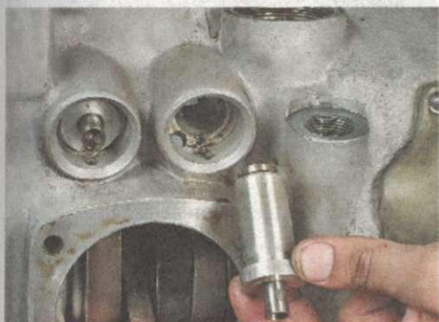
16. Извлекаем толкатель из направляющей.
