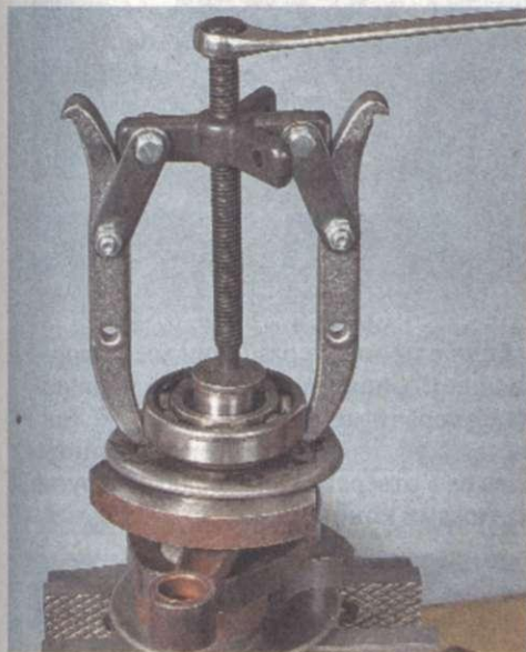
16. Снимаем подшипник.
