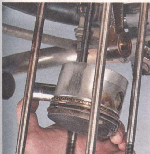
5. Снимаем поршень.
