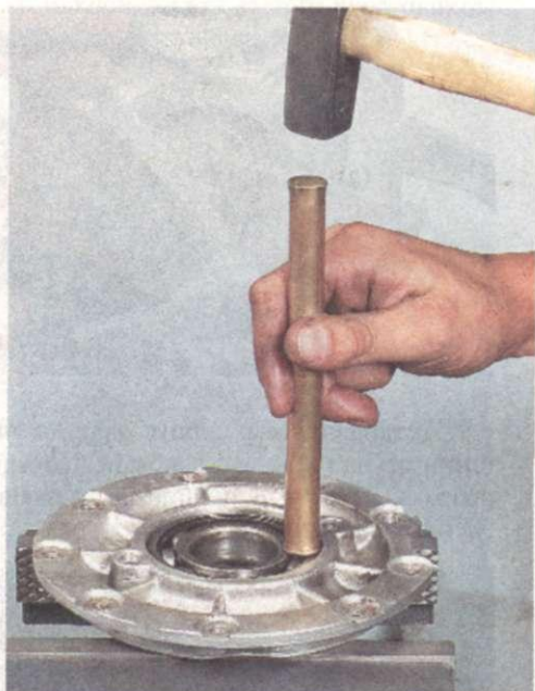
11. Устанавливаем на место стопорное кольцо подшипника.
