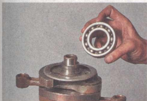
16. Снимаем подшипник.
