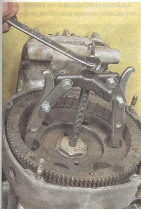
5. Снимаем маховик с коленчатого вала.
