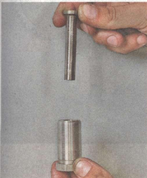
16. Извлекаем толкатель из направляющей.
