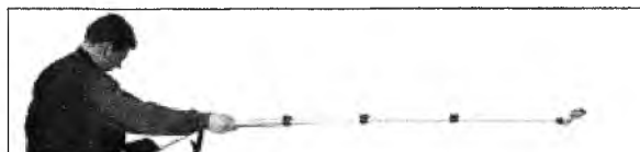
Телевизионное госмотровое устройство «Поиск-ТВ» в разложенном состоянии
