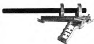
Фото 4. Внешний вид трубчатого направленного микрофона РК1 2925
