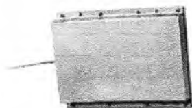
Антенна с излучением перпендикулярно плоскости
