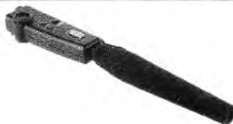
Фото 5. Внешний вид трубчатого направленного микрофона УКН
