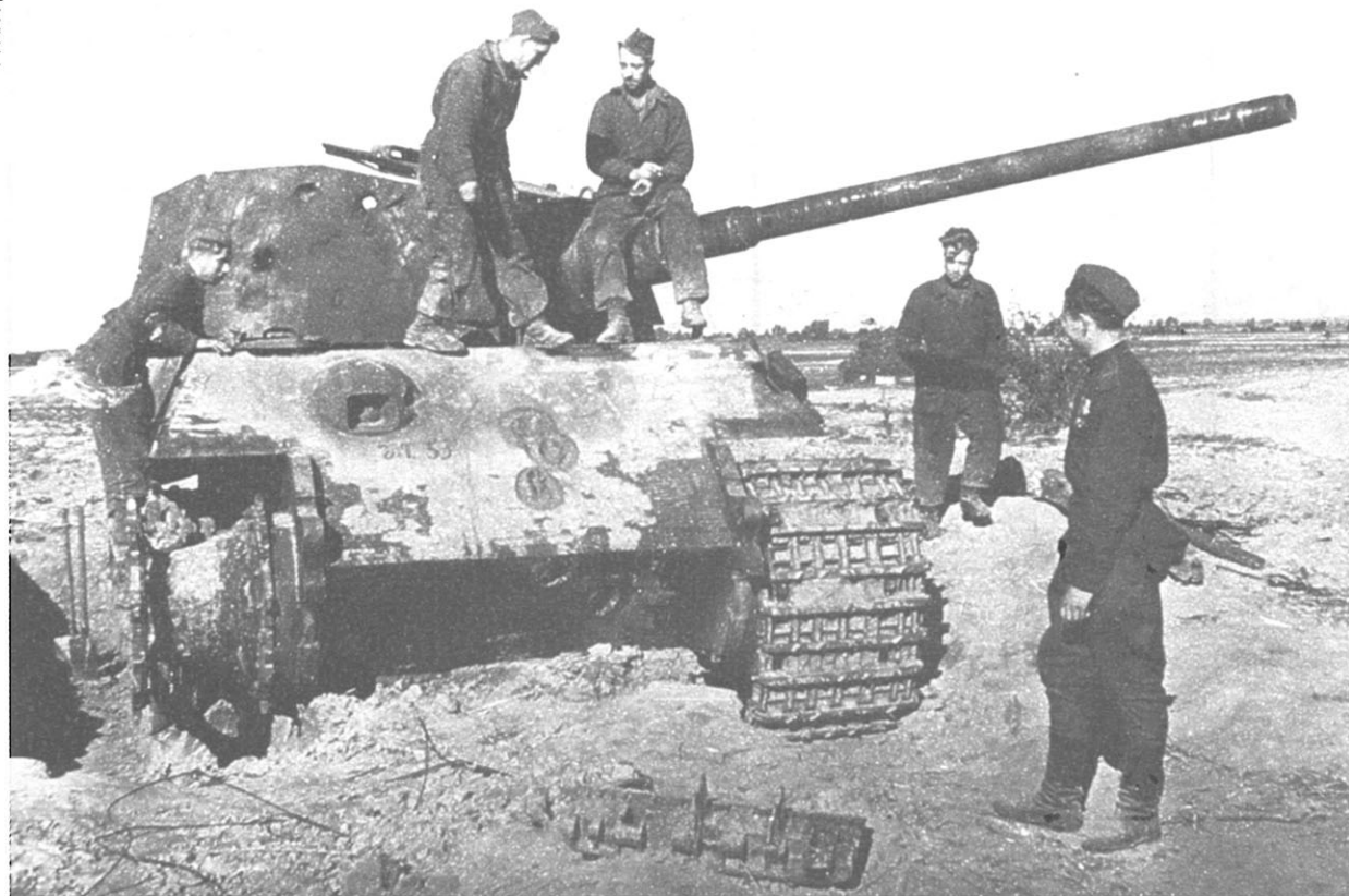
Красноармейцы осматривают «Тигр-Б», подбитый на Сандомирском плацдарме. Судя по отсутствующей задней части крыши, у этого танка сдетонировал боекомплект в нише башни
