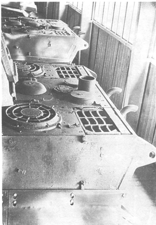
«Королевский тигр» № 502 в Кубинке. На крыше моторного отделения хорошо виден броневой стакан антенного ввода второй радиостанции — свидетельство того, что это командирская машина
